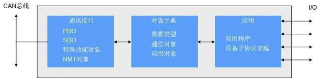
图 2.1 canopen 设备模型
